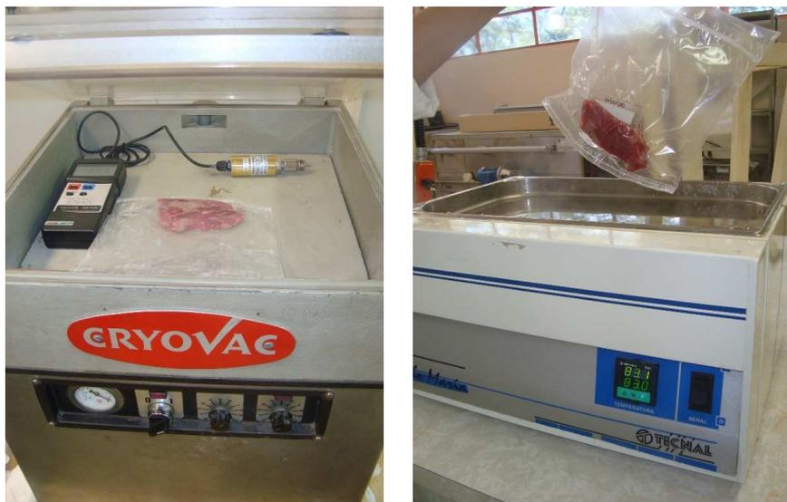
Figura 4. Bife já inoculado e envolto por embalagem EVA multicamada no interior da seladora (esquerda) e banho ajustado em 83°C para realização do termo-
