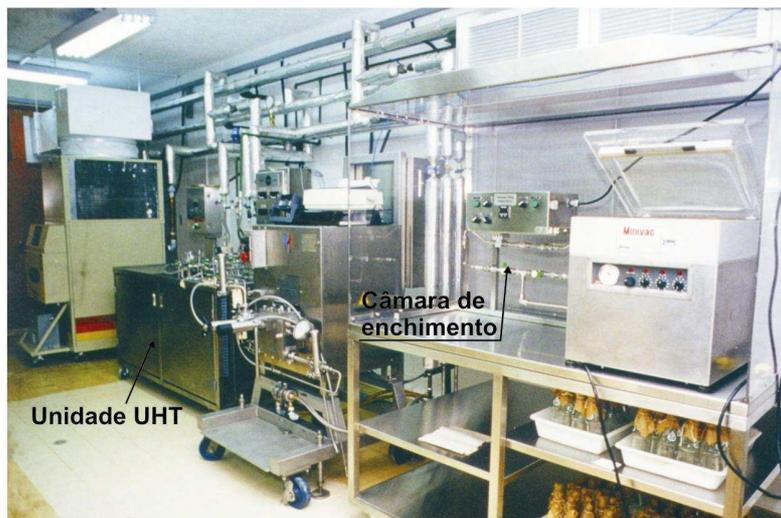
Figura 3.1. Unidade UHT/HTST no Laboratório de Termobacteriologia.
