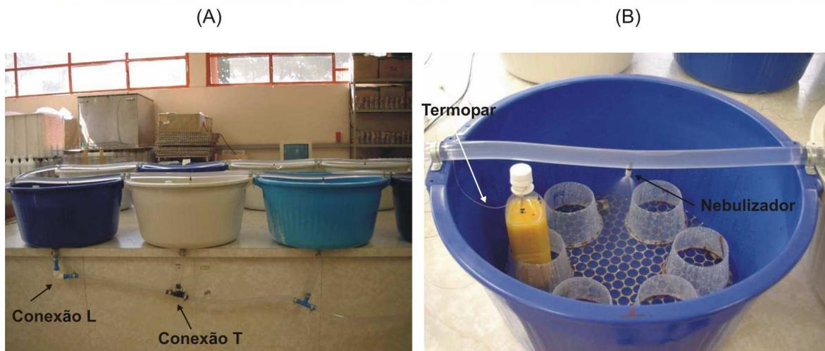
Figura 3.4. (a) Montagem de mangueiras para descarte da água; (b) Detalhe de uma bacia: grade, suportes, nebulizador, garrafa com suco e termopar.
