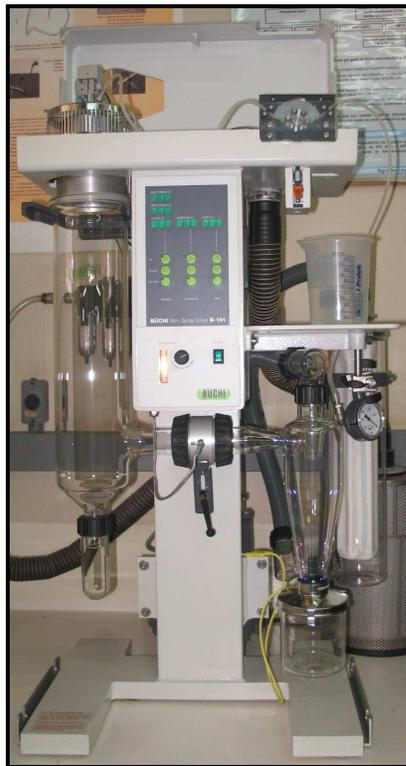
**Figura 23 – *Spray dryer* laboratorial, marca BÜCHI, modelo B-191, utilizado nos ensaios de secagem por atomização.**
