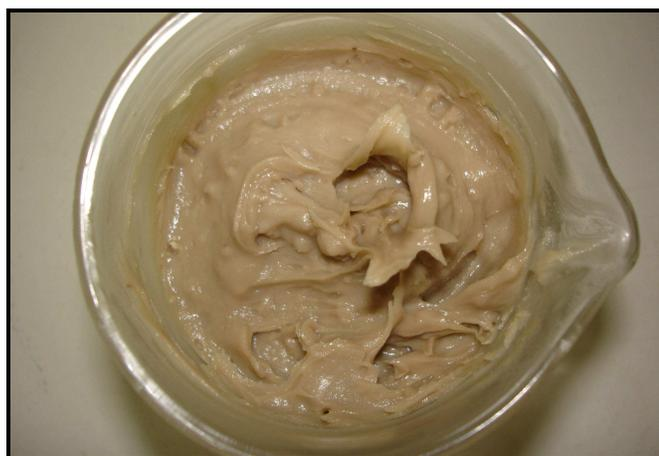
**Figura 35 – Aspecto do precipitado de inulina obtido sob as melhores condições de separação física.**
