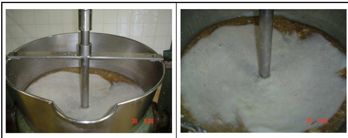
Figura 21 – Tacho encamisado utilizado no processo de extração de inulina.
