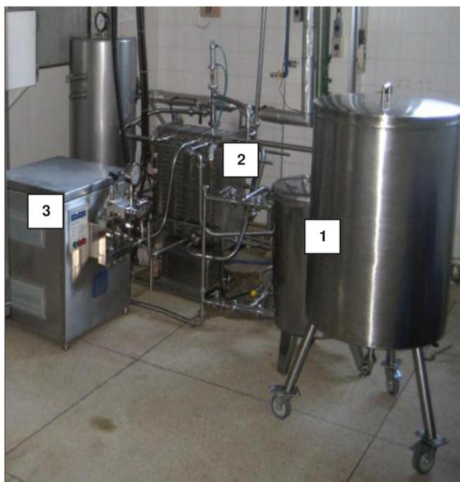
**Figura 8.** Detalhe da linha de processamento UHT mostrando: 1) tanques de matéria-prima; 2) trocador de calor; 3) homogeneizador.
