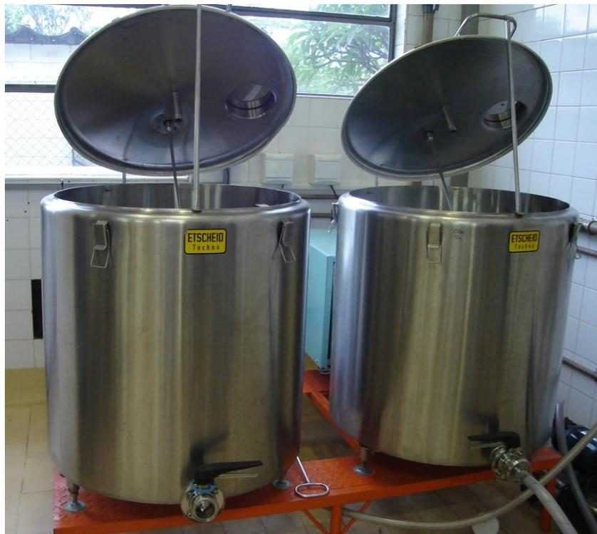
**Figura 6.** Tanques de expansão utilizados para o armazenamento do leite cru.
