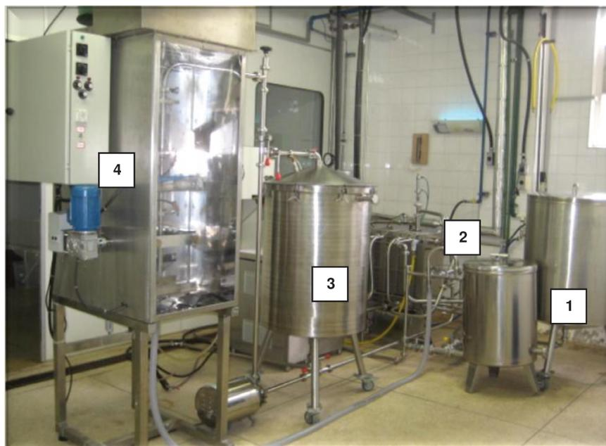
**Figura 7.** Linha de processamento UHT e embalagem asséptica com o tanque de produto e acessórios para o envase. 1) tanques de matéria-prima; 2) trocador de calor; 3) tanque de produto; 4) máquina de embalagem asséptica.
