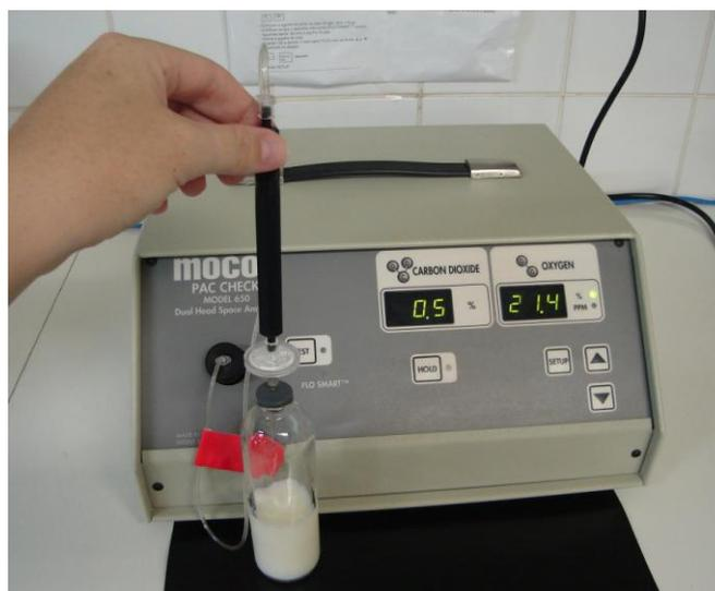
**Figura 3.** Analisador de CO<sub>2</sub> MOCON Pac Check 650.
