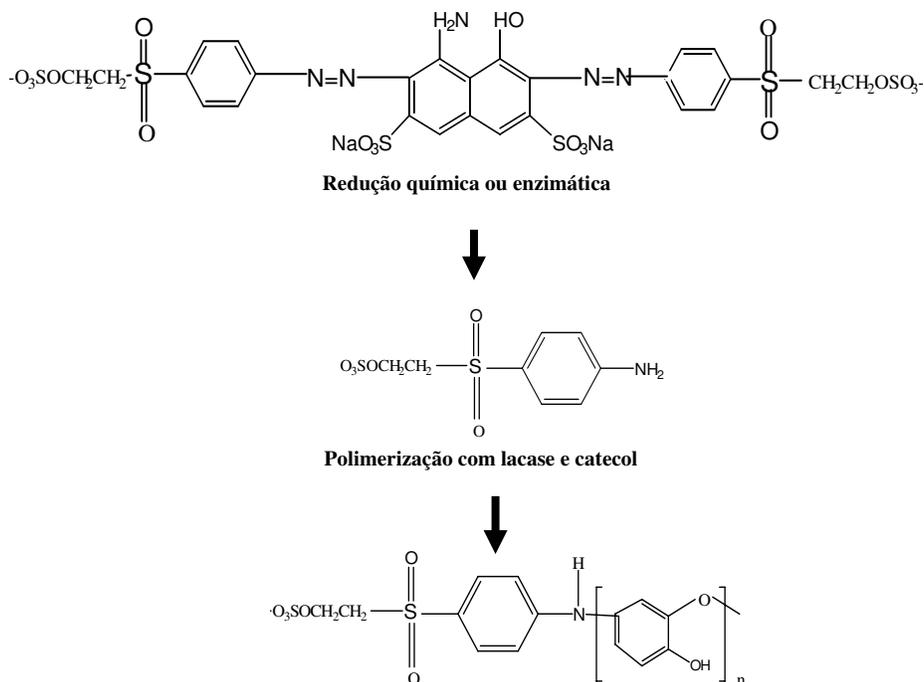
**Figura 2.** Polimerização enzimática do corante Preto Reactivo 5
