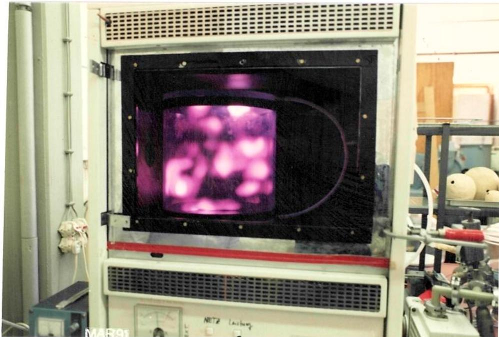
Figura 4 Visualização da distribuição do campo elétrico em forno de microondas (Rudolf,1989)
