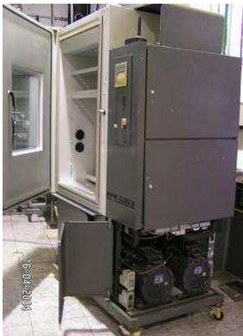
**Figura 2:** Câmara de congelamento utilizada para congelamento dos pães pré-assados.
