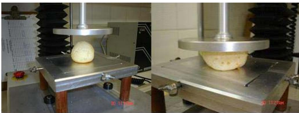
**Figura 4.7** Ensaio de força de compressão no texturômetro TA-XT2 de uma amostra de pão de queijo.
