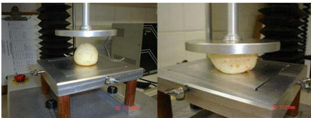
**Figura 2.3** Ensaio de força de compressão no texturômetro TA-XT2 de uma amostra de pão de queijo.
