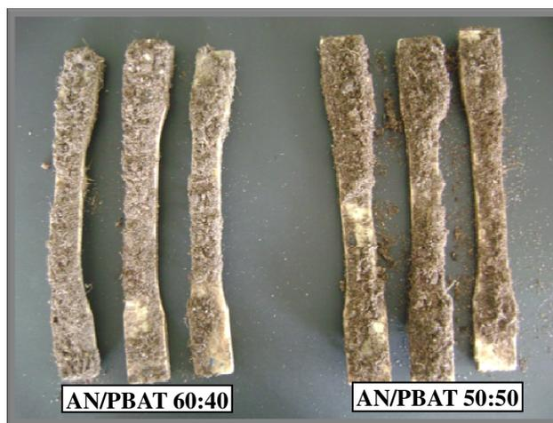
**Figura 2** – Aspecto dos corpos-de-prova das blendas de AN/PBAT 50:50 e AN/PBAT 60:40 ao sair do solo após 15 dias enterrados em solo.
