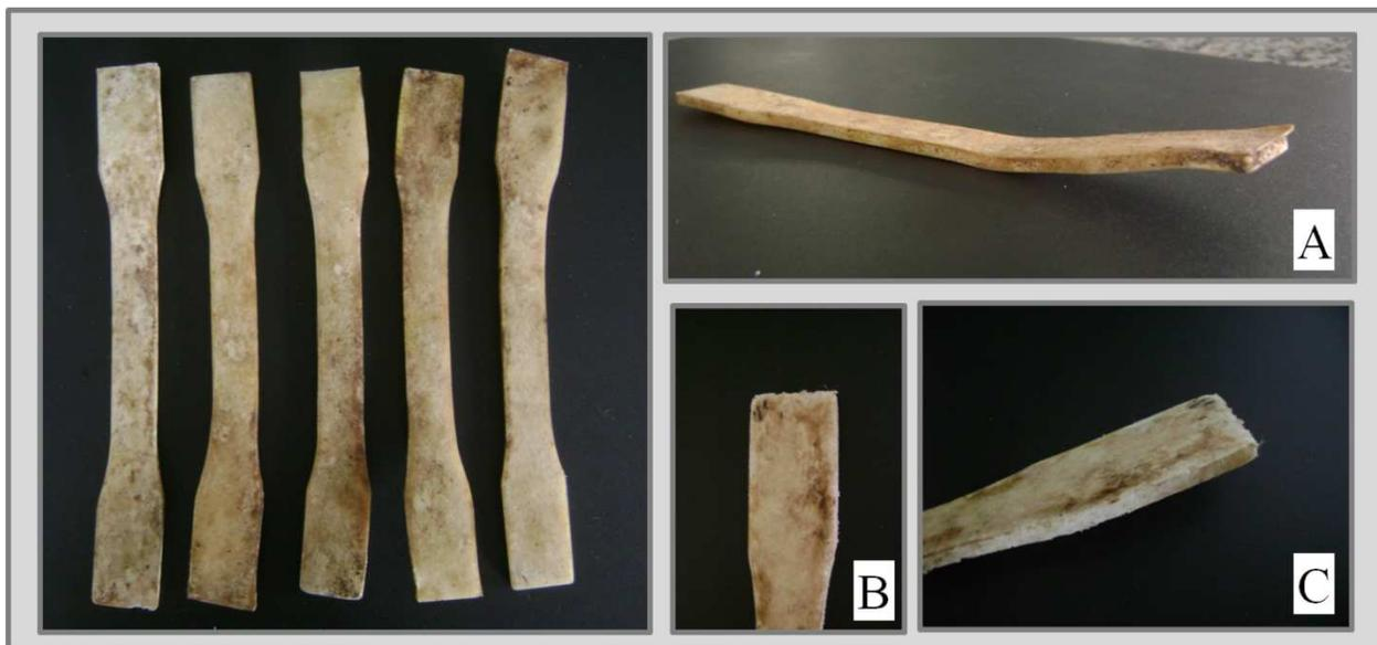
**Figura 4** – Aspecto visual de corpos-de-prova de blendas de AN/PBAT 60:40 após 15 dias em solo. Detalhes em (A) empenamento e (B) e (C) degradação das extremidades.
