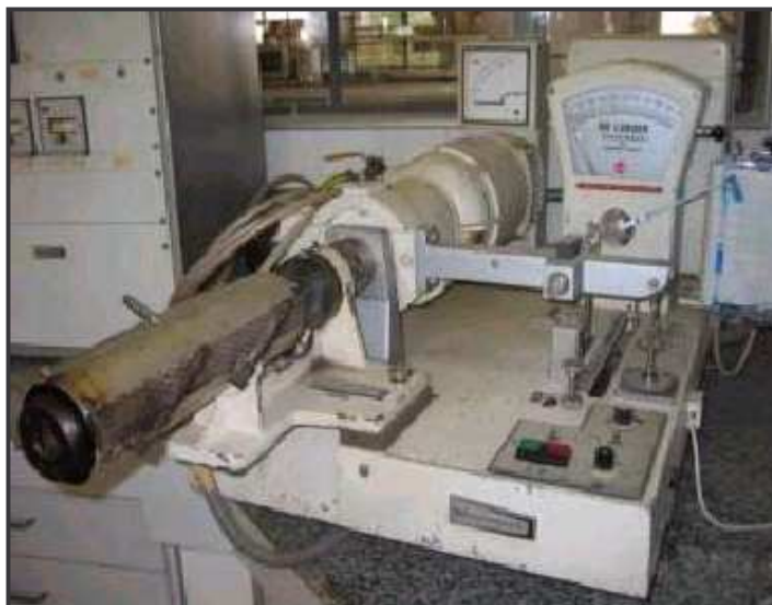
Figura 1: Extrusor mono-rosca utilizado na realização dos ensaios (Laboratório de Cereais, Raízes e Tubérculos – DTA/FEA/UNICAMP)
