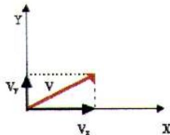
Vetor velocidade  $V$  e as componentes  $V_x$  e  $V_y$ .
