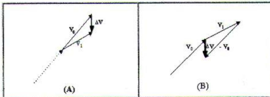
Diferença entre os dois vetores velocidade para duas posições sucessivas.
