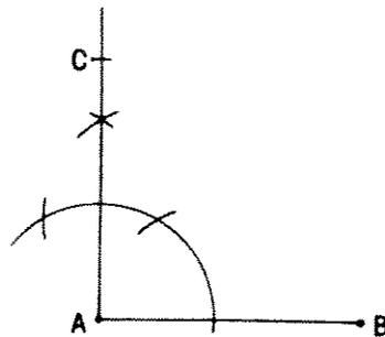
Com a abertura  $\overline{AB}$ , centro do compasso em B, é traçado um arco.
