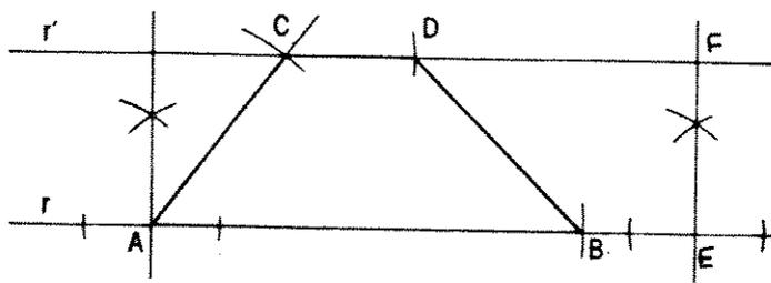
Por esta construção, pode ser observado que a classe dos trapézios não possui os atributos definidores do paralelogramo. O trapézio possui somente um par de retas paralelas, ao passo que o paralelogramo possui dois pares de retas paralelas.
