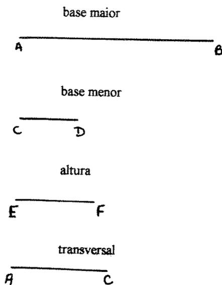
1 - São traçadas duas retas paralelas  $r$  e  $r'$ , paralelas e distantes entre si de uma medida  $EF$  (altura) (ver construção de retas paralelas no anexo II).
