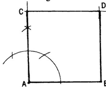
Através dessa construção, podemos notar que, para se obter o quadrado, foi necessário a construção do ângulo reto, utilizando-se a medida do lado  $\overline{AB}$ .
