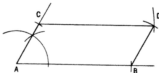
Construímos, portanto, um paralelogramo com as 4 medidas iguais. Logo, o paralelogramo construído é um **Losango**.
