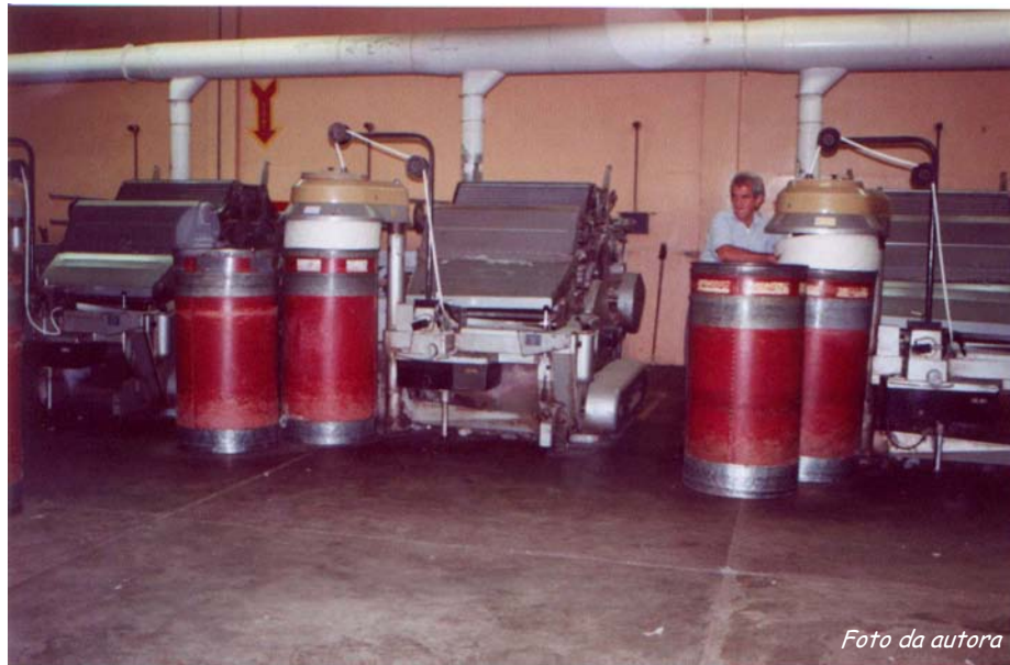
Cooperado na etapa de cardagem realizando o transporte do algodão na forma de pávio.
