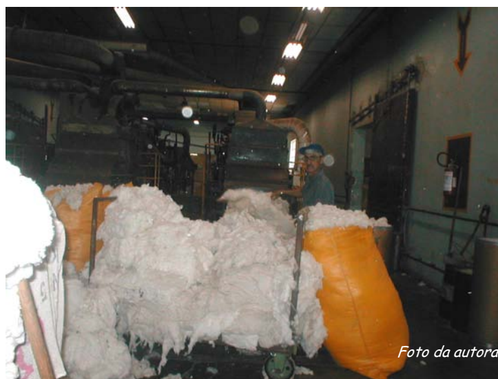
Cooperado do setor de preparação colocando o algodão nos abridores .
