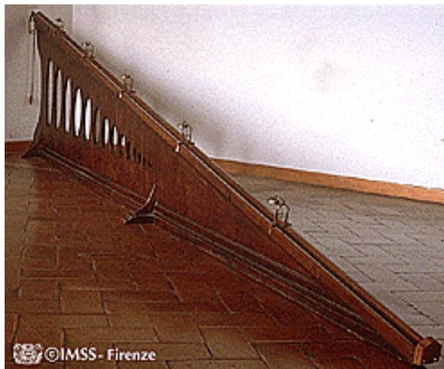
Mantendo fixo o ângulo de inclinação, Galileu mediu os tempos de queda de uma esfera para diferentes distâncias percorridas e, após inúmeras repetições, obteve a proporcionalidade distância - tempo ao quadrado.
