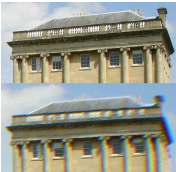
Fig. 10 – Comparação entre fotos com e sem aberração cromática. (Fonte: http://psychology.wikia.com/wiki/Chromatic_aberration )
