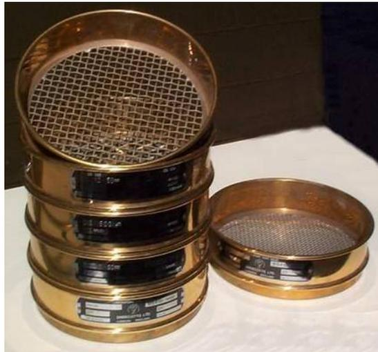
Figura 14. Peneiras geológicas com tela metálica de diâmetro constante.
