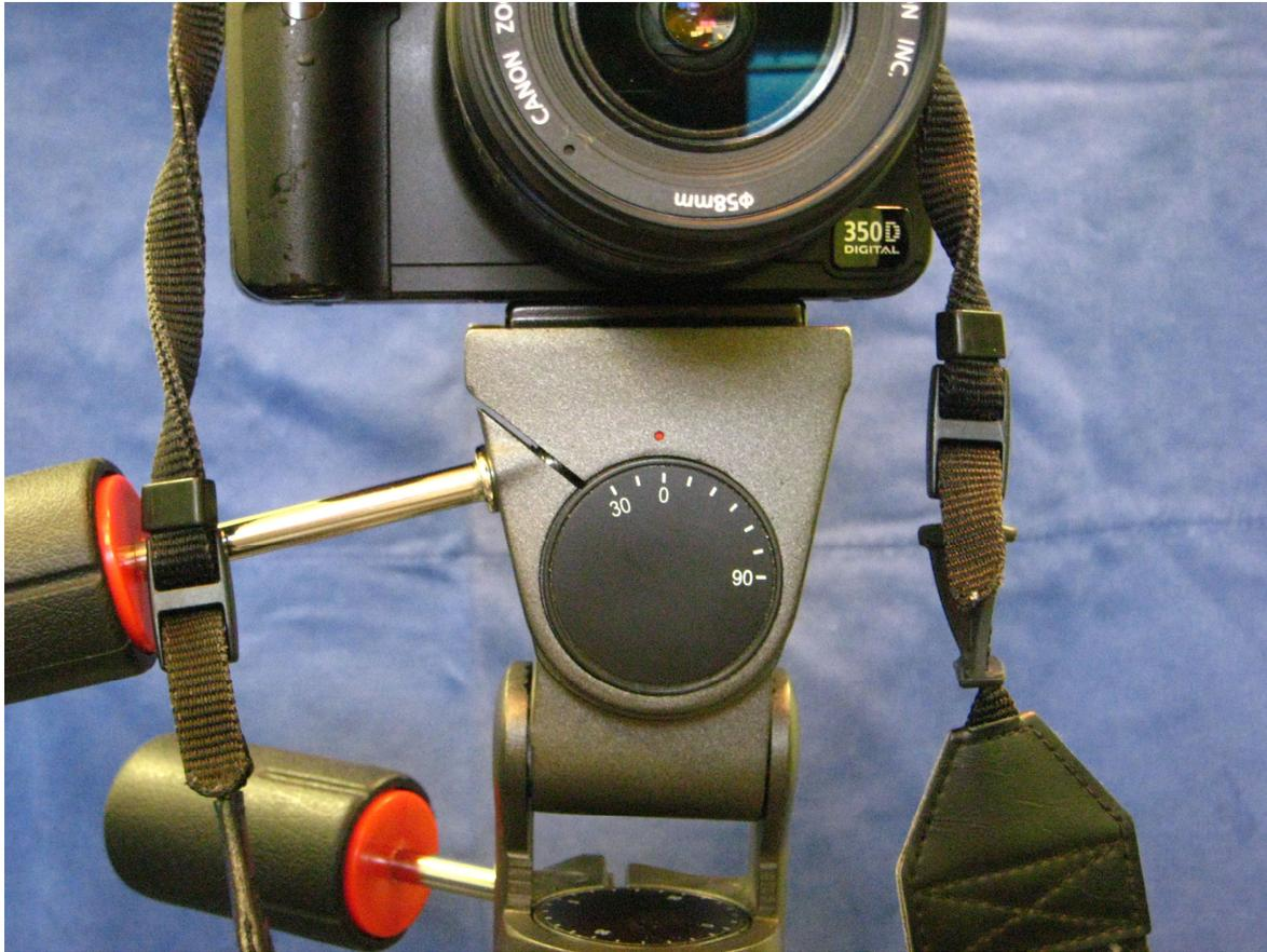
Suporte tripé fotográfico acoplado a sistema de transferidor geométrico.
