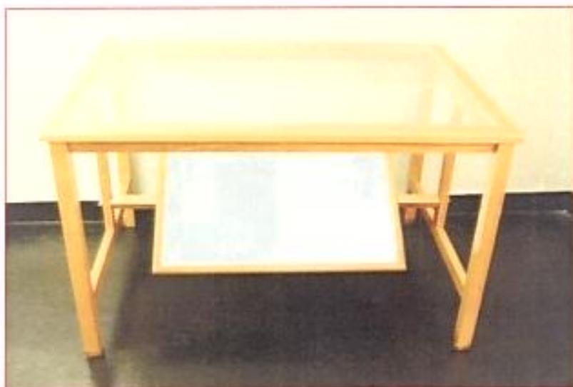
**FIGURA 3.** Mesa de avaliação constituída de tampo de acrílico e acoplada com espelho, posicionado a 45° embaixo dela.
