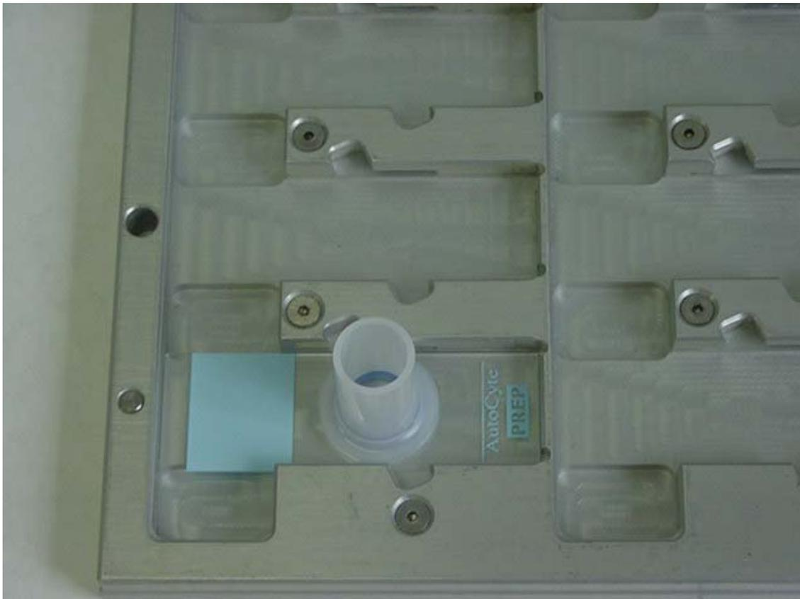
Figura 7. "Slide Rack" (câmara de assentamento das lâminas).
