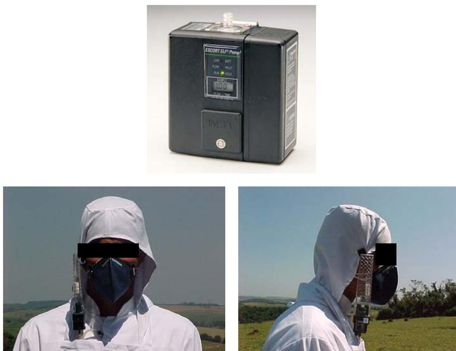
**Figura 6.** Exposição inalatória - Bomba pessoal de amostragem de ar; tubo com adsorvente localizado na região de inalação do trabalhador<sup>(52)</sup>
