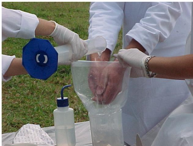
**Figura 4.** Exposição dérmica - Procedimento de lavagem das mãos com água e sabão<sup>(52)</sup>
