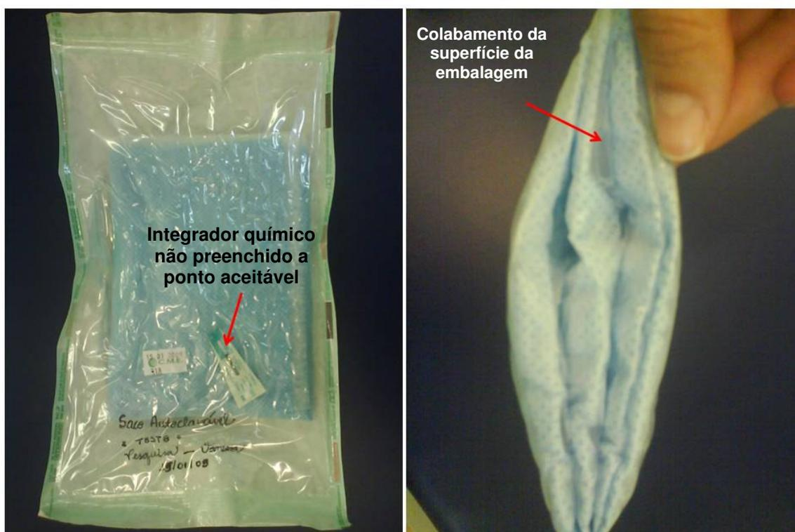
**Figura 21** – Teste com embalagem plástica esterilizada em autoclave pré-vácuo (121° - 20 minutos). Campinas, 2009.
