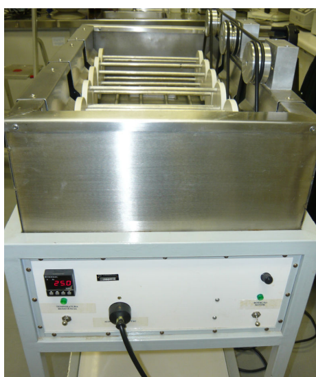
Figura 15. Banho agitador de Tonômetros utilizado para equilíbrio do hemolisado stripped expostos a adições de ar.
