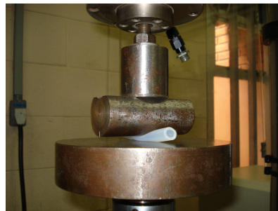
Figura 16b – Detalhe do posicionamento do tubo de silicone.
