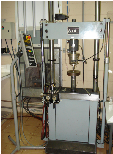
Figura 16a – Vista geral do equipamento usado para ensaios de compressão.
