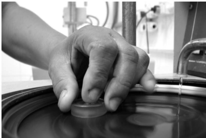
**Figura 4 - Lixamento do cálculo.** Cálculo previamente embutido em resina metalográfica. Granulometrias de 400, 600, 1200 e 2400. Processo de polimento com velocidade de 260 rotações por minuto, resfriado à água.
