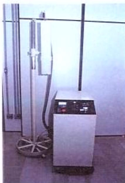
Foto 12 - Laser de CO<sub>2</sub> : protótipo construído no lab. GDAL do IFGW, ainda em funcionamento
