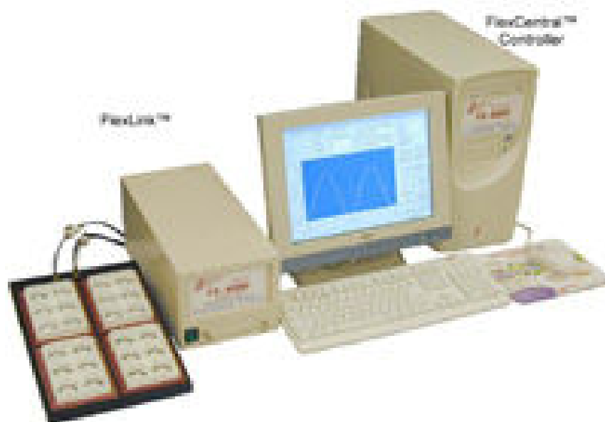
Imagem do equipamento Flexercell, que controla o estiramento mecânico.
