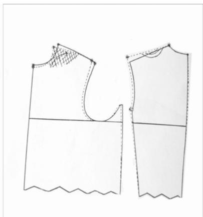
**Moldes** [Fig. 42] – o alfaiate usa o molde para cortar, talhar o tecido. O molde é feito em papel; normalmente são bobinas de papel usadas especialmente para a produção das peças de roupa de um cliente; o molde é feito a partir das medidas tiradas do corpo do freguês; os alfaiates costumam guardar os moldes de cada cliente, uma forma de ganhar tempo na produção; mesmo assim, a cada nova encomenda, o alfaiate costuma conferir as medidas do cliente.
