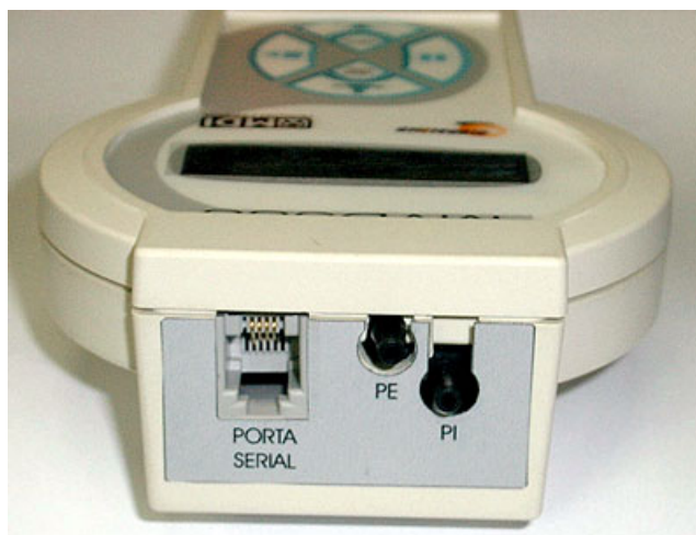
Portas de conexão
