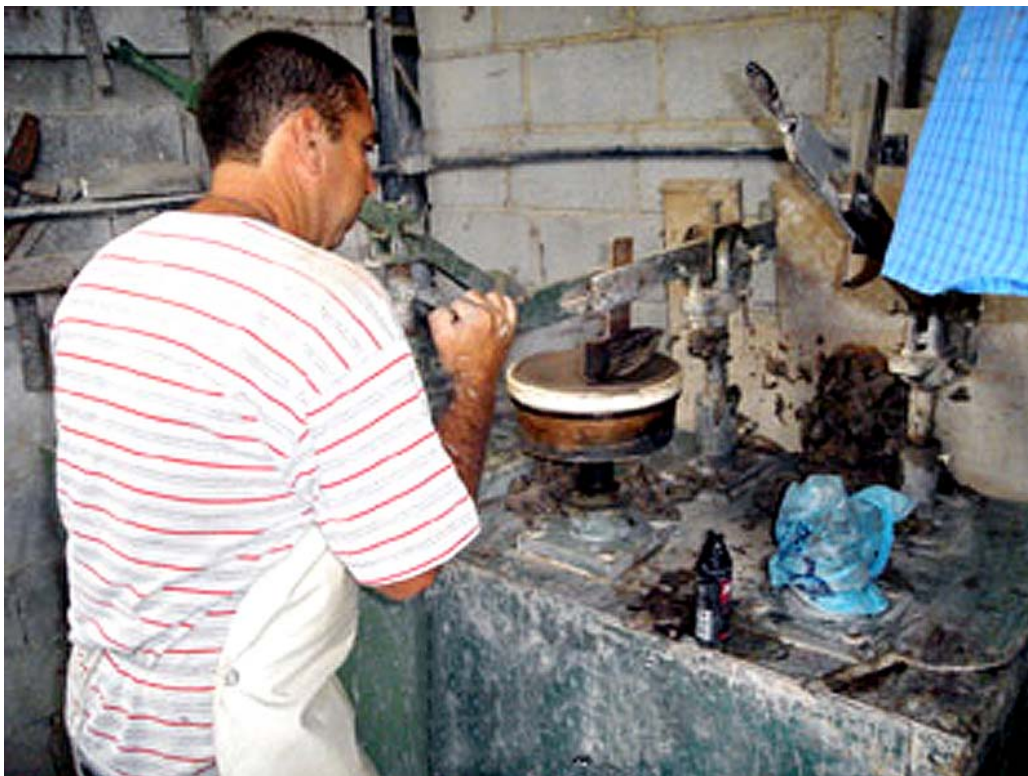
Figura 9- Estampação a torno da massa marombada.
