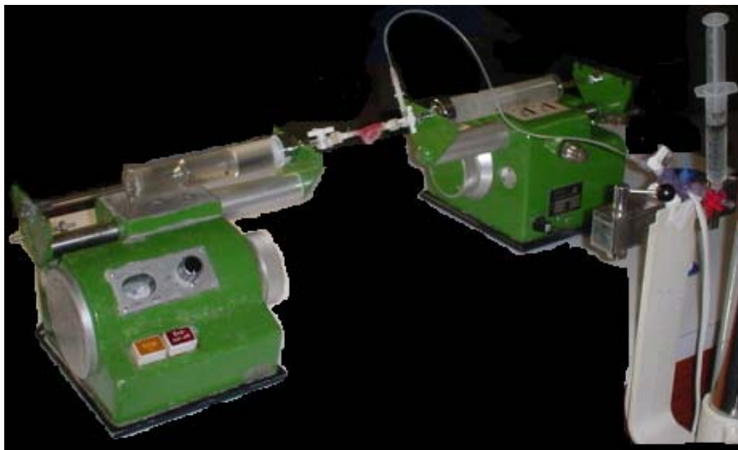
Figura 18 - Teste Pressão de Ruptura a Distensão por Líquido – Pressão de Explosão.
