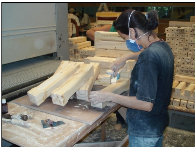
Figura 6- Trabalhador do setor acabamento preparando a madeira para corrigir defeitos de superfície da peça
