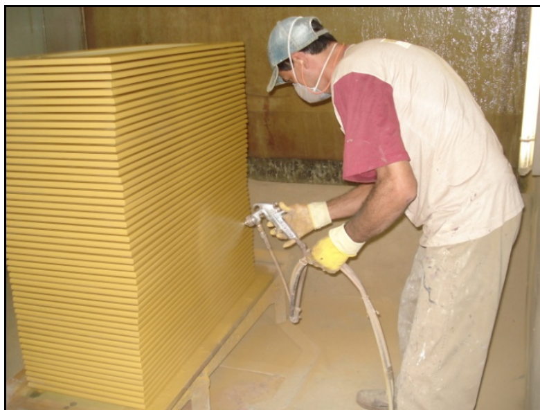
Figura 8- Trabalhador do setor pintura executando a aplicação de verniz
