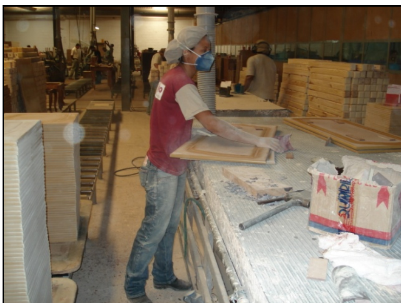
Figura 7- Trabalhador do setor acabamento lixando a superfície do móvel
