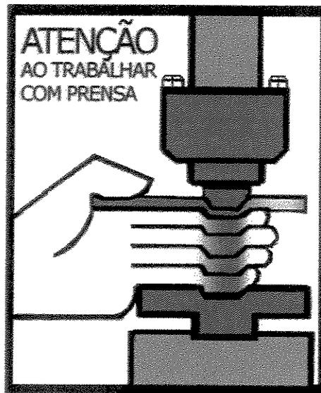
**Detalhe:** cartaz mostra a mão do trabalhador sendo prensada ao ingressar na zona de operação do equipamento. A máquina desprotegida permite o acesso da mão na zona de risco, em desacordo com as normas atuais de proteção (NR12 e NBR 13...). O cartaz induz a uma culpabilização transferindo a responsabilidade para o operador. A máquina sem proteção pode ser operada desde que o operador preste atenção, tome cuidado. (SESI, 2000).
