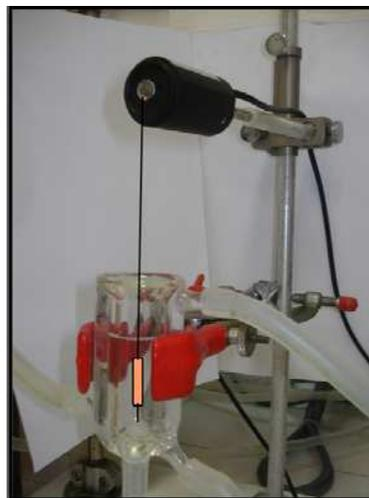
**Figura 1:** Sistema de câmara de incubação para órgão isolado.
