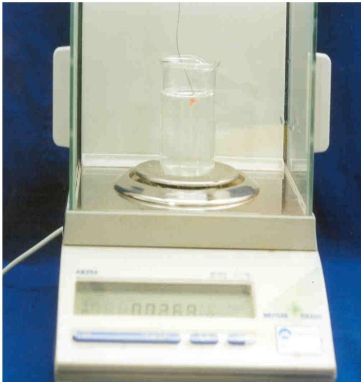
**Figura 3-** Demonstração do Método de pesagem de Scherle
