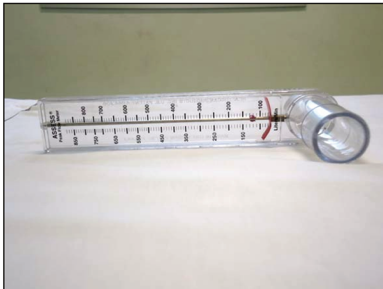
Figura 4- Peak Flow Meter . Equipamento para medida do Pico de Fluxo Expiratório. Marca ASSESS®
