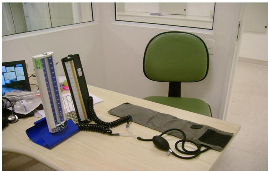
**Figura 2** – Montagem do esfigmomanômetros de coluna de mercúrio com o manguito.
