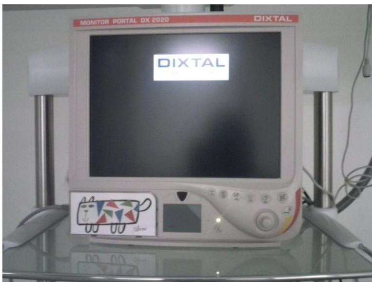
**Figura 5** - Monitor multiparamétrico automático de braço marca Dixtal® e modelo DX 2020.
