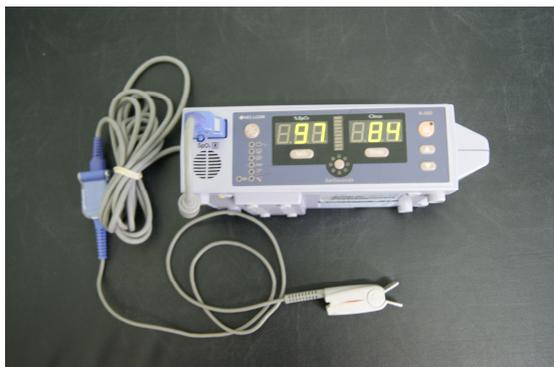
Figura 4 - Aparelho de oximetria mostrando os valores de SaO<sub>2</sub> e FC respectivamente.
