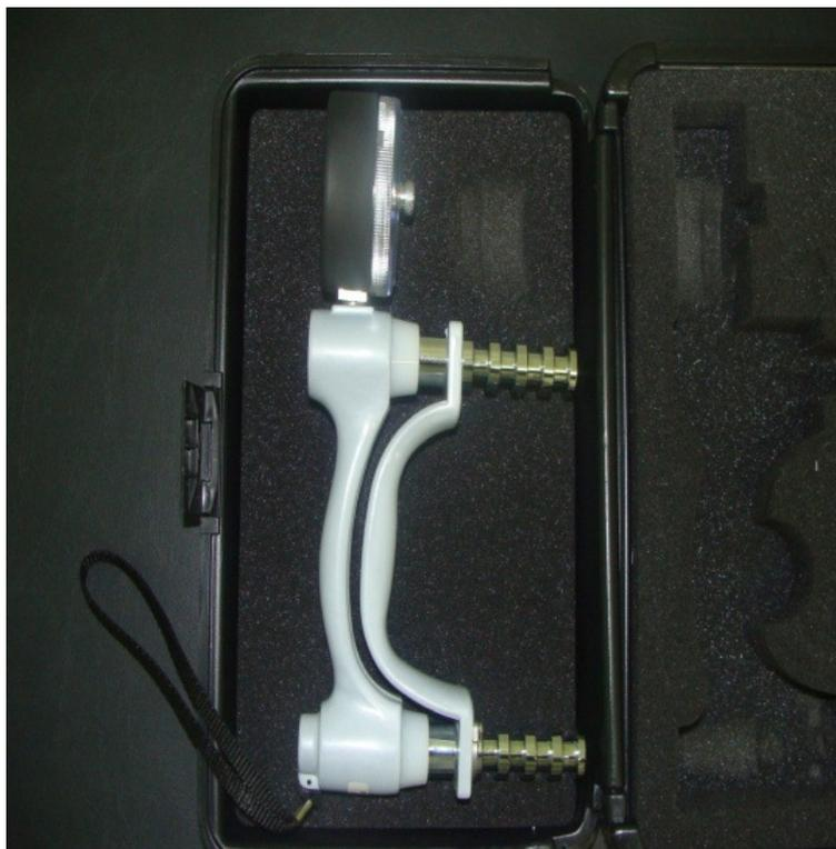
Figura 5 - vista do perfil do dinamômetro hidráulico.
