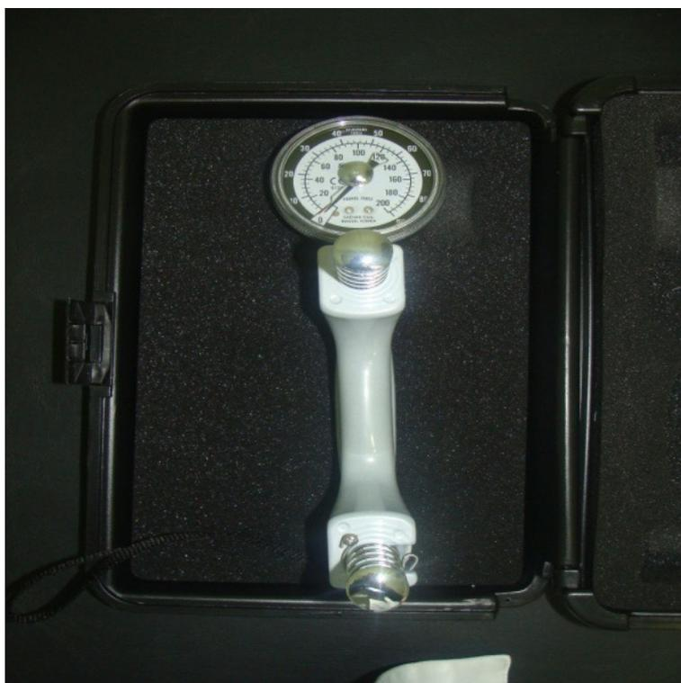
Figura 6 - vista frontal do dinamômetro hidráulico.
