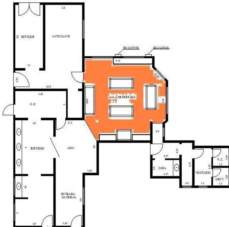
**Figura 8. Planta física da sala de preparo.**
