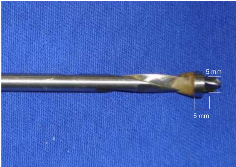
**Figura 5-** Visualização da broca metálica com 5 mm de diâmetro apresentando anel fixado a 5 mm de sua extremidade.
