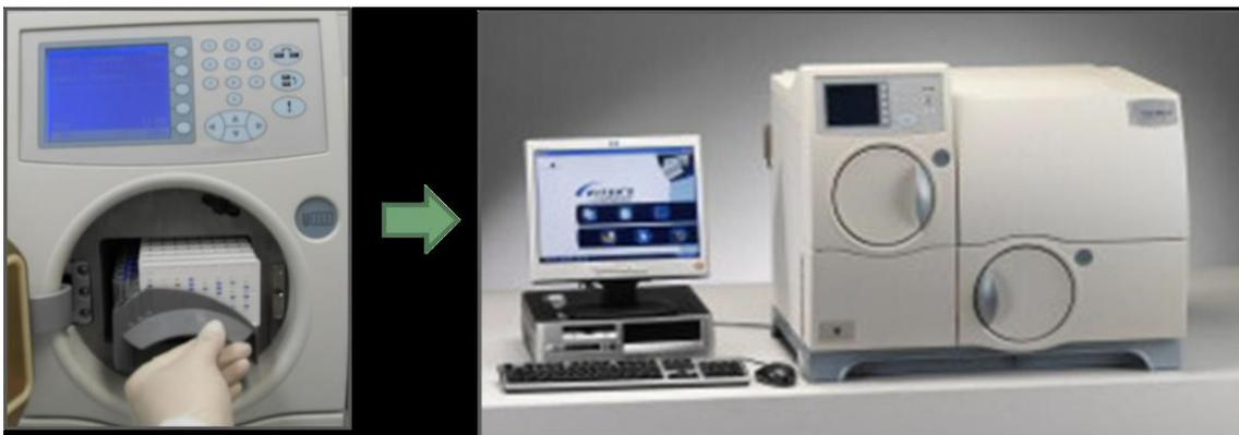
Figura 2 - Selagem e incubação dos cartões de identificação do sistema automatizado Vitek®2 (BioMeriéux) (80)
