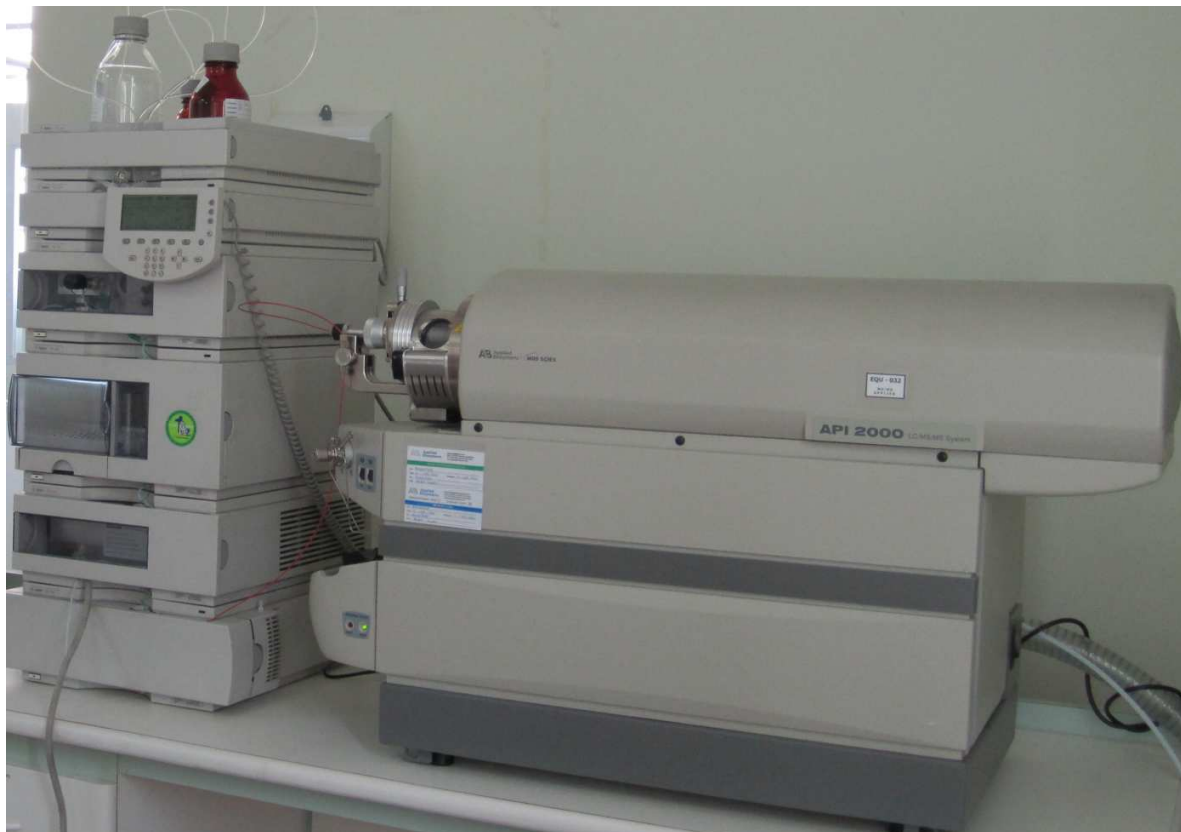
Figura 11: Sistema cromatográfico utilizado para as análises, composto por um cromatógrafo líquido de alta eficiência (HPLC) acoplado a um espectrômetro de massa (MS/MS).
