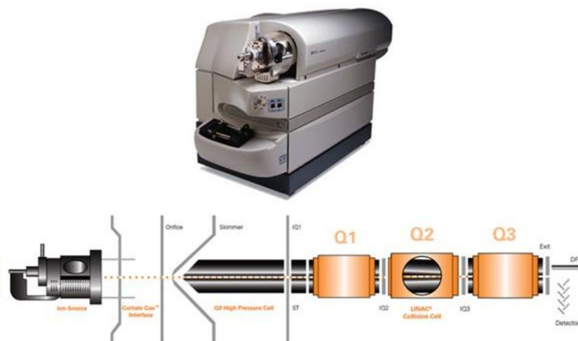
Figura 7: Uma foto ilustrativa do equipamento Q-TRAP (acima) e um esquema da configuração interna do equipamento (abaixo)<sup>42</sup>
