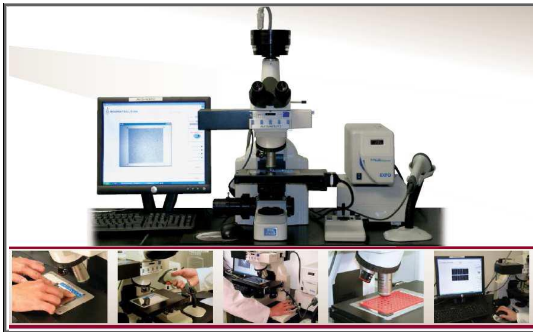
Figura 5: Sistema automatizado de captura e análise de dados AIS 400 (Array Imaging System). Este sistema é formado por um microscópio de fluorescência acoplado a um leitor de código de barras e a um computador. Cada lâmina contendo os chips de DNA possui um código de barras que a identifica e fornece ao sistema importante informações sobre a localização das beads na lâmina.
