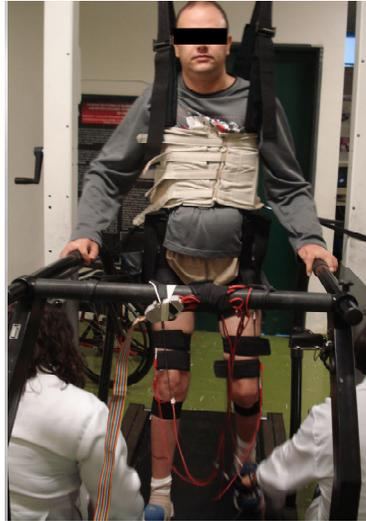
**Figura 6:** Equipamento de suporte e suspensão para tetraplégicos realizarem EENM na esteira.
