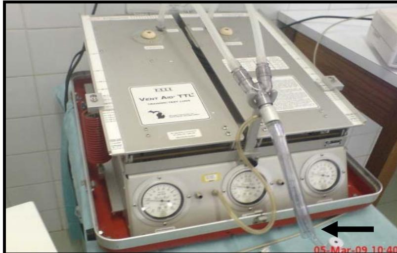
**Figura 4** - Equipamento de simulação pulmonar (Pulmão Test) Vent Aid® TTL Training/Test Lung (Michigan Instruments Incorporation, Michigan, MC). Notar a traqueia artificial onde o TETM é introduzido para estudo(seta).
