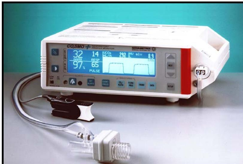
**Figura 5** - Monitor de perfil respiratório CO2SMO PLUS DX 8100 com sensor de fluxo - Dixtal/Novametrix, São Paulo, Brasil, para estudo do perfil respiratório e análise dos dados.
