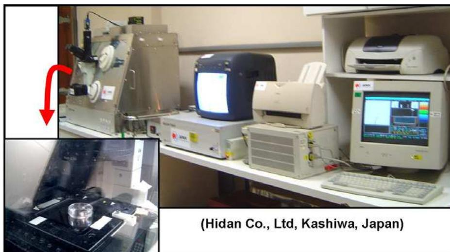
**Figura 3-** Fotografia do aparelho BioCell-Tracer<sup>®</sup>. O equipamento é constituído de um microscópio com base para as placas, uma câmara de vídeo, um televisor com aparelho de vídeo, um digitalizador de imagens e um microcomputador. No detalhe da foto, a imagem da placa que irá ser analisada dentro da câmara do equipamento.
