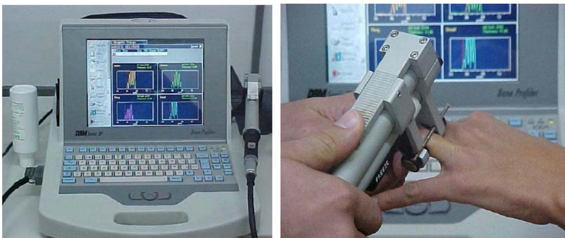
**Figura 1-** Equipamento DBM *Sonic BP* (IGEA, Carpi, Italy) e posicionamento do compasso na metáfise distal da mão para realização da avaliação.
