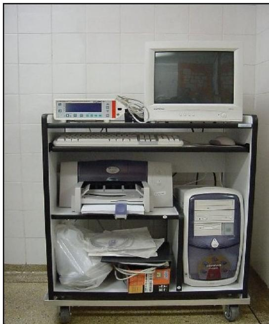
Figura 6: Monitor CO<sub>2</sub>SMO Plus® conectado a um computador com software para registro das medidas e curvas.
