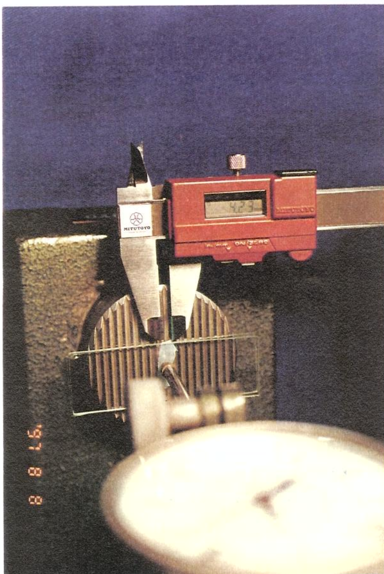
Figura 11: Paquímetro quadrimensional digital Mitutoyo Digimatic 500/215 com o qual medimos o comprimento útil e a largura dos corpos de prova
