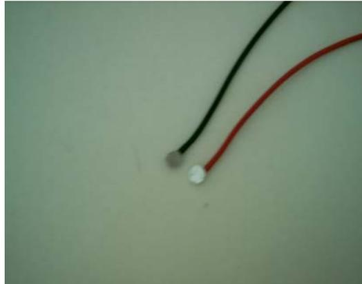
**Figura 15-** Adequação dos equipamentos utilizados na realização da iontoforese no camundongo. **A:** aparelho utilizado acoplado ao par de eletrodos. **B:** Par de eletrodos (cabo preto, polaridade negativa; cabo vermelho, polaridade positiva) confeccionados para a utilização em camundongos.
