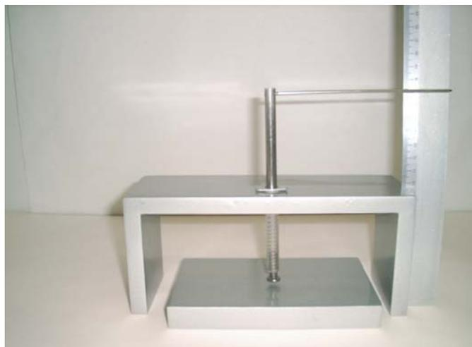
**Figura 11-** Dispositivo para indução de hemartrose através de um sistema de mola.
